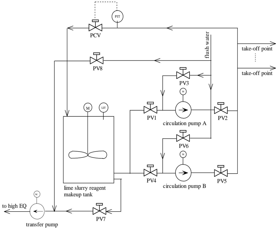
Figure 2.10.5 Lime Slurry Circulation System
